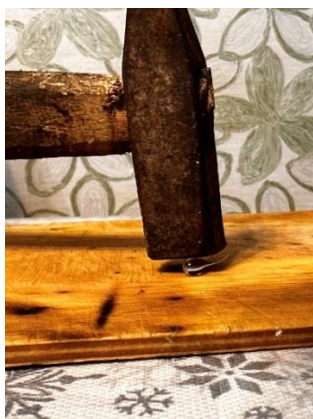
Рис. 6 Проверка капли Руперта на прочность Рис. 7 Отломленный «хвостик» капли
