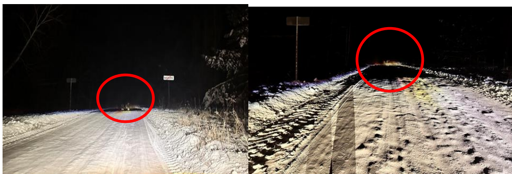
Рис. 4 Светоотражатели при ближнем и дальнем свете фар
