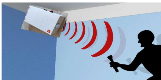
Рис.8. Изображение принципа действия сигнализации с датчиком движения
